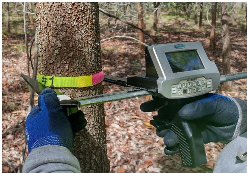
*Imagen 21: Calibración de diámetro digital para medición y registro de datos*
